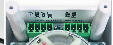
Foto 20. Klemmen zum Anschluss eines externen +12V-Netzteils, eines kabelgebundenen Schalters, zum Kombinieren mehrerer elektrischer Kugelantriebe zu einem System
