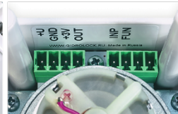
Foto 13. Klemmen zum Anschluss von kabelgebundenen Wasserlecksensoren: INP, GND
